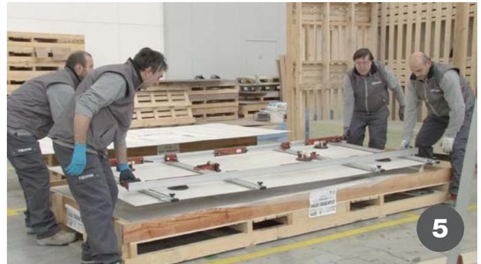
Alzare la lastra seguendo il lato lungo e posizionarla in verticale, utilizzando i manici del telaio **(6)**.
