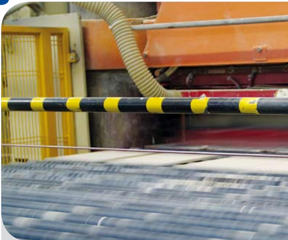
На этом этапе формованная плитка пока ещё не готова к обжигу, так как её остаточная степень влажности слишком высока. Поэтому плитка перемещается в **СУШИЛКУ**, расположенную на линии сразу после прессы. Функция сушилки – довести степень влажности плитки до значения, близкого к нулю. Далее, сохраняя температуру 80-100°C, плитка возвращается на линию для последующей обработки.
