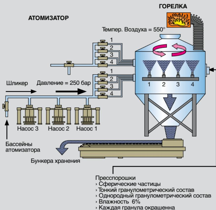
Содержащийся в бассейнах шликер при помощи насосов подаётся в атолизатор. Это огромный стальной цилиндр, оснащённый газовой горелкой, которая доводит внутреннюю температуру до 550 градусов. Проходя под высоким давлением через форсунки,
