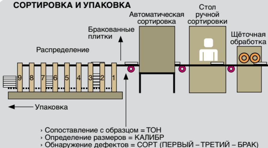
Последний этап процесса изготовления керамогранита – сортировка.
