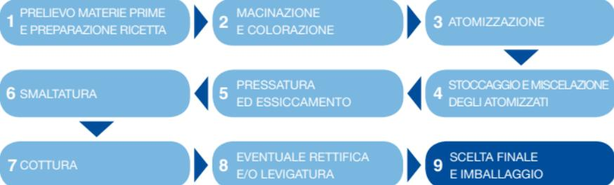
romatiche superficiali. La determinazione del calibro di ogni piastrella è sempre un processo automatizzato, mentre quella del tono può essere sia manuale, seguita da personale specializzato, sia, negli impianti più moderni, anch'essa automatizzata.
