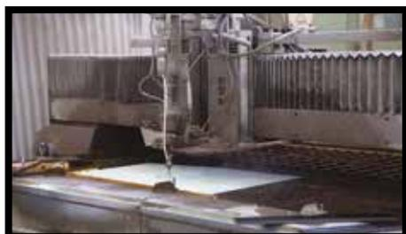
**Рис. 17.** Все разновидности плит KERLITE можно резать на гидроабразивных станках. Рекомендуется работать со скоростью от 2 до 3 м/мин.
