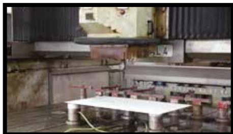
**Рис. 16.** Все разновидности плит KERLITE можно резать на станках с числовым программным управлением. Фреза в таких станках должна вращаться со скоростью от 12 000 до 18 000 об./мин., при этом поступательная скорость колеблется от 0,5 до 1 м/мин.
