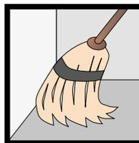
**Рис. 26.** Поверхность основы должна быть чистой. Следует удалить пыль, масло, жир, грязь и строительный мусор, так как они могут снизить адгезию клея.
