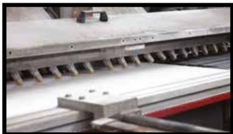
**Рис. 21.** Для резки под углом 45° можно использовать алмазные диски со скосом под углом 45°, что позволяет выполнить кромку сразу на двух плитах KERLITE любого типа. После этого необходимо сгладить угол новой кромки. С помощью разных дисков можно получить различные варианты отделки кромки. Скорость обработки нужно проверить заранее.
