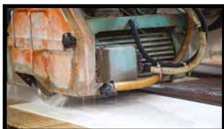
**Рис. 15.** Все разновидности плит KERLITE можно резать алмазными дисками. Следует выбрать специальные диски, предназначенные для резки керамогранита и находящиеся в хорошем состоянии. Рекомендуется работать на высокой скорости вращения (>2000 об./мин.) и поступательной скорости от 0,5 до 1 м/мин. В зависимости от типа диска и длины реза может потребоваться водяное охлаждение диска. В то же время, на входе и выходе инструмента из плиты рекомендуется снижать скорость вращения.
