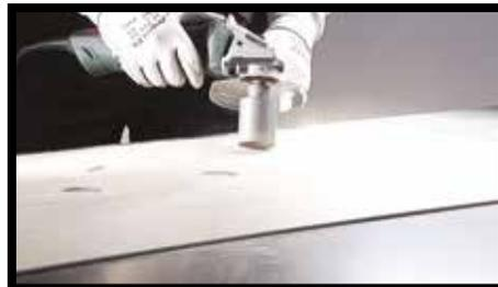
**Рис. 9-10.** Как альтернативный вариант можно использовать корончатые фрезы или пустотелые сверла, установленные на шлифовальную машину, электрическую дрель или шурупверт на аккумуляторах.
