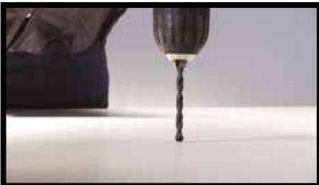
**Рис. 8.** Для сверления отверстий вручную используются вольфрамовые сверла диаметром до 10 мм, установленные на электрическую дрель или шурупверт на аккумуляторах.
